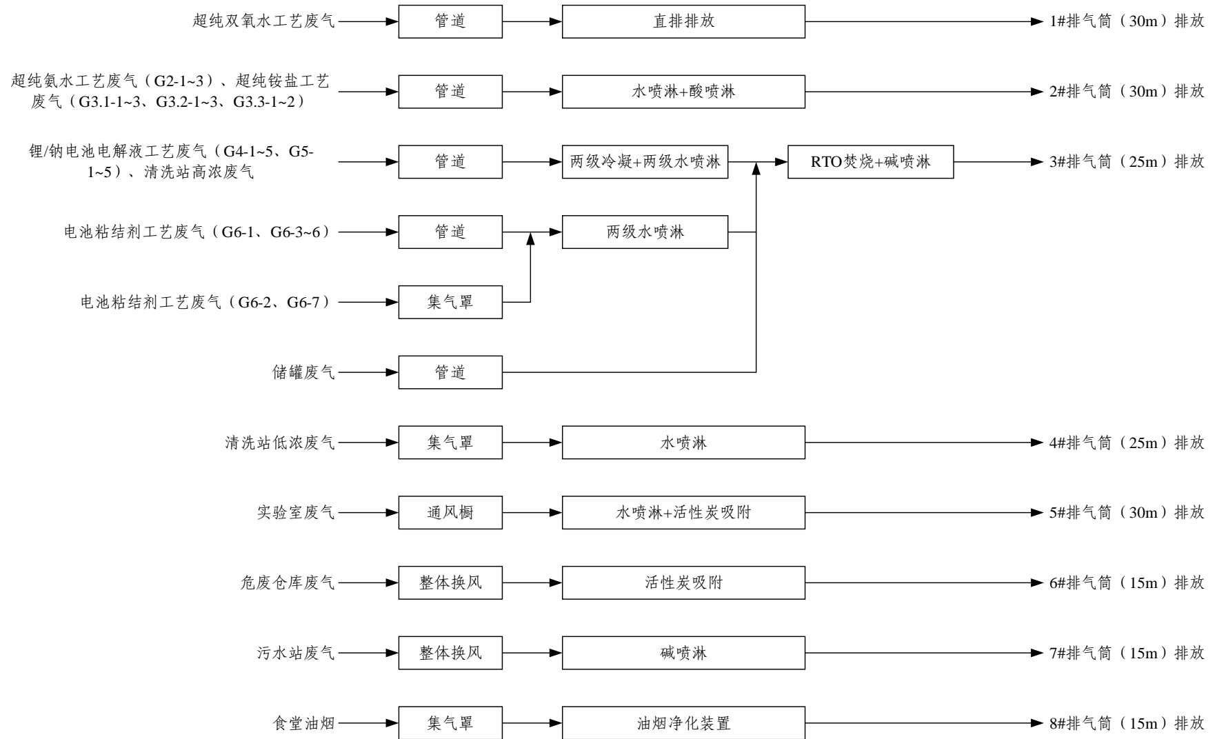
图 6.1.1 建设项目废气处理路线图
